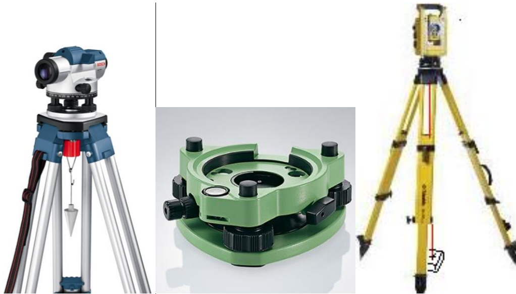
Slika 18. Centrisanje običnim, optičkim i laserskim viskom
